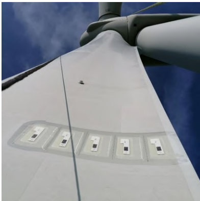
Beispiel einer eologix:align Installation für kontinuierliche Blattwinkel-messung
